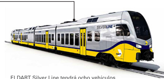
El DART Silver Line tendrá ocho vehículos diesel-eléctricos construidos por Stadler Inc.
